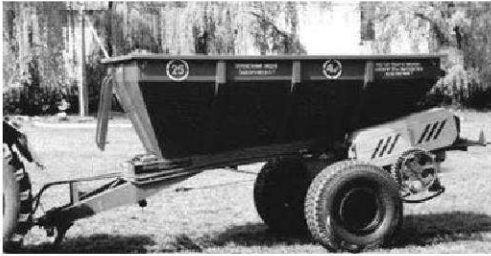
Рис. 2. Машина для розсівання мінеральних добрив МРД-4 з приводом відцентрового диска від гідромотора, обладнаного гідравлічною обгінною муфтою
