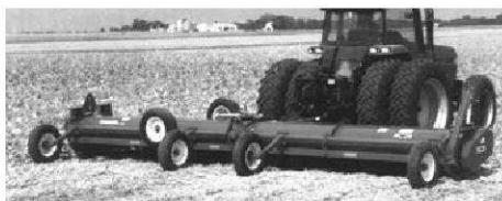
**Рис. 7.** Машина з горизонтальним робочим органом RC 25 фірми Phino (США) шириною захвату 7,62 м
