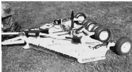
**Рис. 21.** Машина з вертикальними робочими органами з зубчастим приводом S 150 фірми SCHULTE (Канада) ширину захвату 4,57 м
