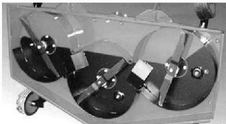
**Рис. 10.** Різальні органи машини XRM 235 фірми Del Morino (Італія) з шириною захвату 2,35 м
