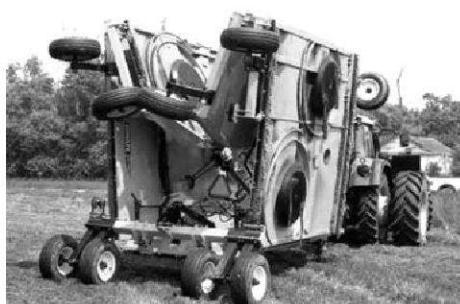
**Рис. 12.** Машина з вертикальними робочими органами з дисковими тримачами FX 742 фірми Schulte (Канада) шириною захвату 12,8 м (в транспортному положенні)
