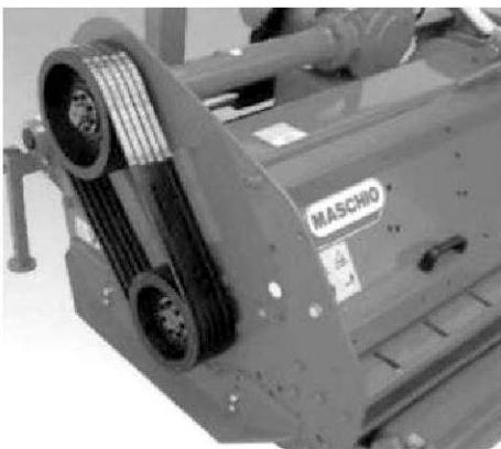
**Рис. 4.** Привод різального барабана машини TIGRE 300 фірми Maschio (Італія)
