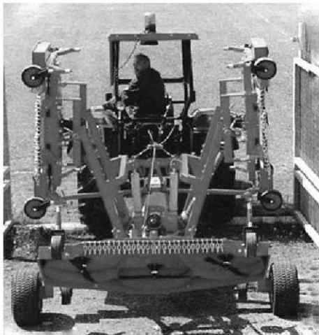
**Рис. 17.** Машина з вертикальними робочими органами OMEGA 11 фірми Del Morino (Італія) з ланцюговими передніми стінками обичайки кожуха, ширину захвату 3,25 м, начіплені на гідрофіковану причіпну зчіпку
