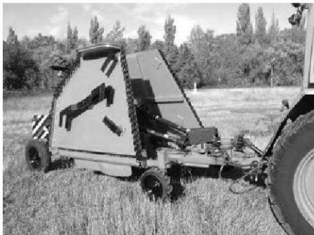
**Рис. 22.** Машина з вертикальними робочими органами ПРН-4,5 шириною захвату 4,5 м, розроблена ННЦ “ІМЕСГ”, виготовляється ВАТ “Красилівський машинобудівний завод”
