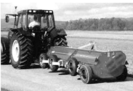
**Рис. 9.** Начіпна машина з горизонтальним робочим органом RM 400 фірми Kuhn (Франція) з шириною захвату 4 м (в транспортному положенні)
