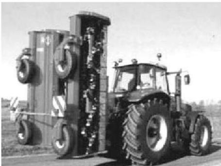
**Рис. 8.** Машина з горизонтальним робочим органом RM 610 фірми Kuhn (Франція) з шириною захвату 6,1 м (в транспортному положенні)
