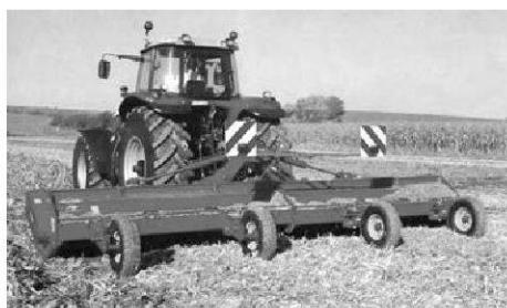
**Рис. 1.** Машина з горизонтальним робочим органом RM 610 фірми Kuhn (Франція) з шириною захвату 6,1 м
