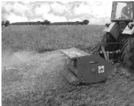
**Рис. 5.** Машина з горизонтальним робочим органом IMT 618.059 фірми Standart (Сербія) шириною захвату 2,8 м з поворотним щитком
