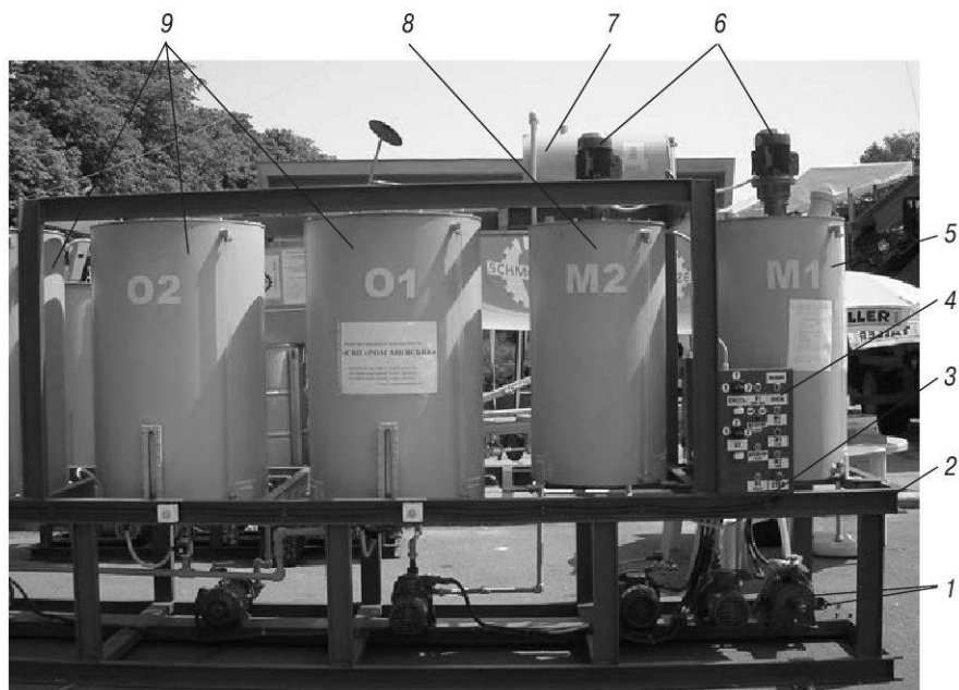
Рис. 2. Загальний вид установки UBME-1000-1250: 1 — насоси типу КМ; 2 — рама; 3 — система трубопроводів; 4 — пульт керування; 5 — реактор реакції обміну; 6 — електродвигуни приводу активаторів; 7 — дозатор метилату калію; 8 — реактор реакції переетерифікації; 9 — відстійники
