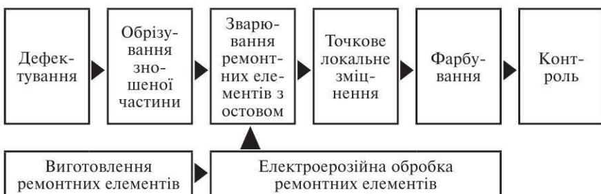
**Рис. 1.** Схема технологічного процесу відновлення лап культиваторів
