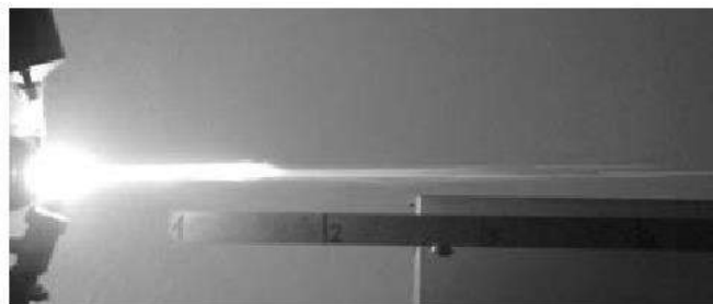
Рис. 3. Загальний вигляд ламінарного плазмового струменя при напленні порошку.
