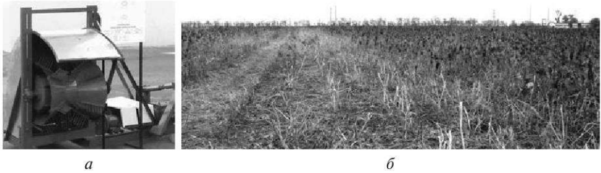
Рис. 3. Дослідний зразок для збирання рицини очосом (а) і вигляд поля після його проходу (б)
