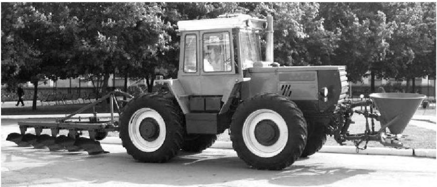
Рис. 2. Комбінований МТА на основі трактора серії ХТЗ-160
