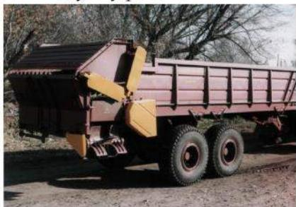
**Рис. 1.** Навісний модуль на розкидачі ПРТ-7
