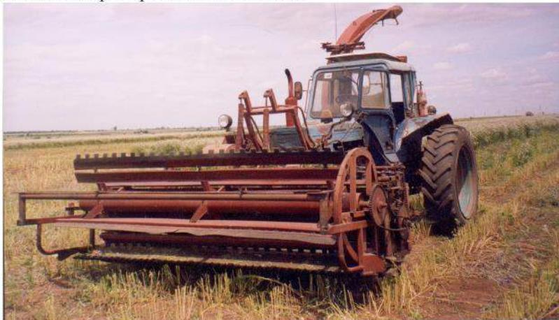
**Рис. 1.** Навесной кормоуборочный комбайн ЖЛ – 3,2. Вид спереди.
