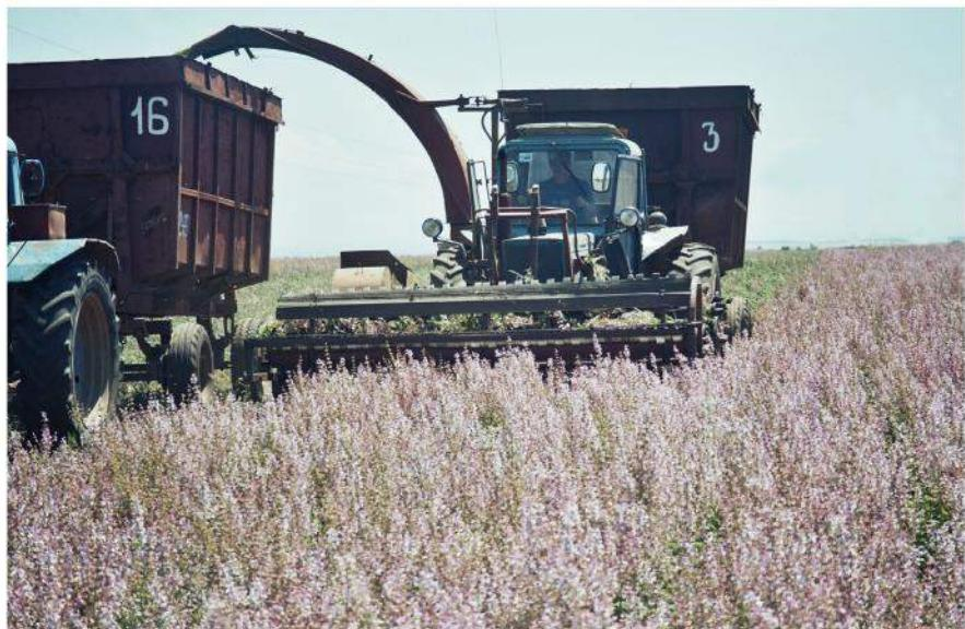
Рис. 2. Комбайн ЖЛ – 3,2 на уборке шалфея мускатного
