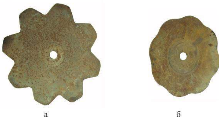
Рис. 1. Диски важкої борони з наробітком 20 га (а) та 80 га (б)
