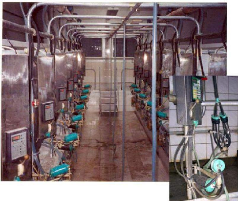
**Рис. 2.** Доїльний зал «Ялинка» модульного приміщення для безприв'язного утримання корів
