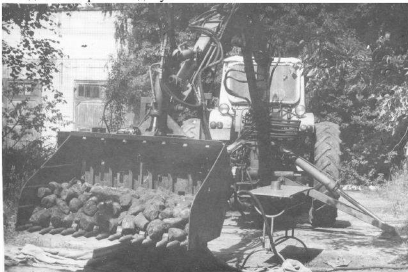
Рис. Загальний вигляд ковша з рухомими граблями
