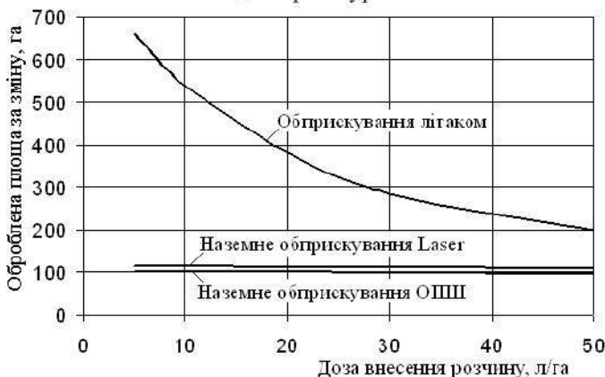
Рис. 5. Залежність розмірів обробленої площі поля літаком ХІАТ-650СХ і наземними технічними засобами на операції хімічного захисту рослин від дози внесення розчину.
