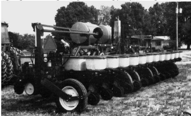
Рис. 2. Сівалка з програмованою нормою висіву з набором пристроїв «ACCU-PLANT»
