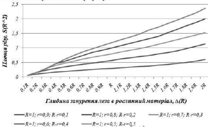
Рис. 5. Графік зміни площі різання S(R^2) кільцевого поперечного перерізу від глибини занурення леза \Delta в рослинну масу
