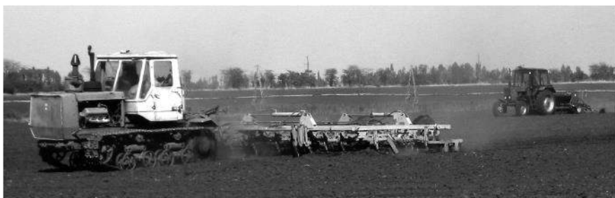
Рис. 3. Передпосівний обробіток агрегатом Т-150 + АП-6 і сівба ріпаку агрегатом МТЗ-82 + D9-40 Super
