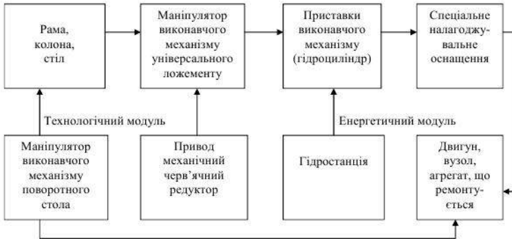
Рис. 3. Принципова схема універсального блочно-модульного стенда для ремонту двигунів та вузлів і агрегатів шасі тракторів, складних сільськогосподарських машин
