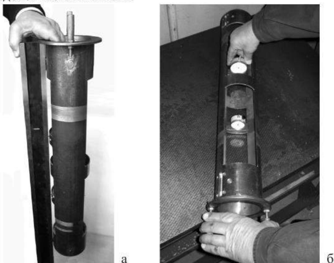
Рис. 2. Установка індикаторів за допомогою лекальної лінійки (а) і на плиті (б)
