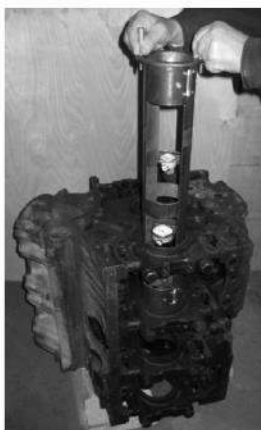
Рис. 5. Установка пристрою у гнізда корінних опор
