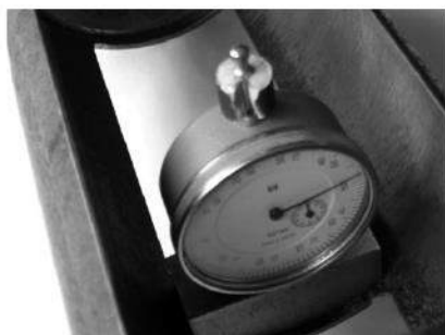
Рис. 3. Закріплення стержня в утопленому положенні
