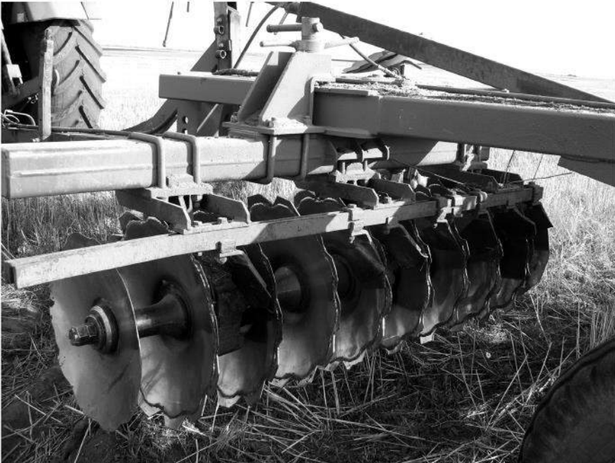
Рис. 3. Загальний вигляд секції дискової борони АКРІЛ з дисками, які зміцнені методом ЕО, встановленими для проведення експлуатаційних польових досліджень
