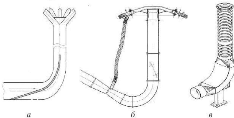
**Рис. 3.** Розрізняльні форми переходів (отводів): а – сітчастий направильник; б – наклонна решітка; в – прямоугольний поворот
