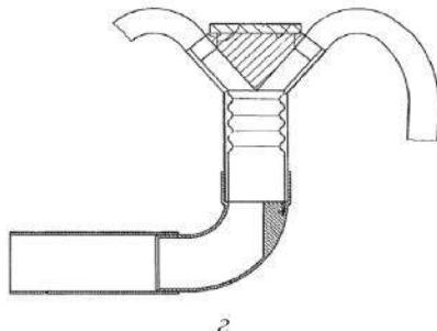
**Рис. 2.** Типы вертикальных распределителей пассивного действия: а – «Amazone»; б – «Accord»; в – «Flexi-Coil»; г – «Lemken»
