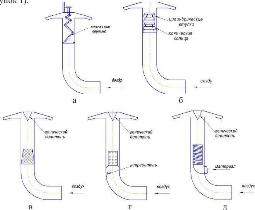
**Рис. 1.** Типи центраторів і турбулизаторів посевного матеріалу:
