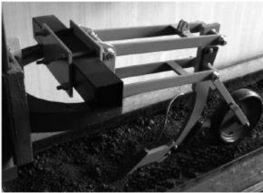
Рис. 1. Загальний вигляд та схема посівної секції сівалки прямого посіву: 1 – кронштейн; 2 – паралелограмна підвіска; 3 – стояк; 4 – стебловідвід; 5 – долото; 6 – сектор регулювання глибини; 7 – на-сіннепровід; 8 – поводиток; 9 – коток
