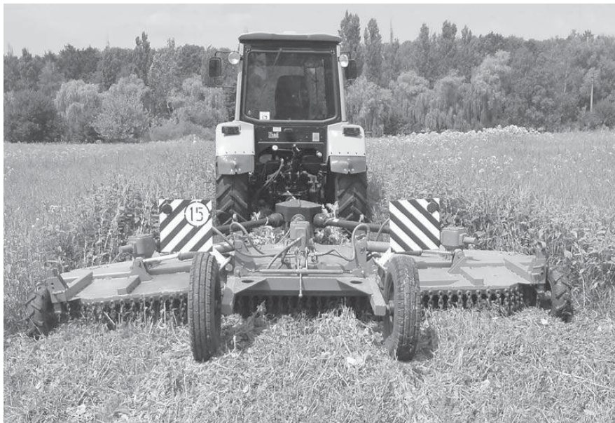
Рис. 1. Подрібнювач рослинних решток ПРР-4,5
