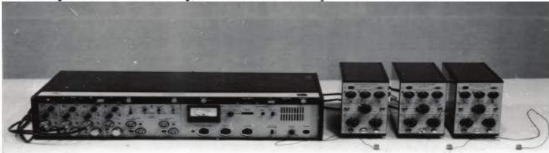
Рис. 2. Апаратура фірми „Брюль і К’єр” для реєстрації вібраційних сигналів: реєстратор 7005; підсилювачі сигналу 2635
