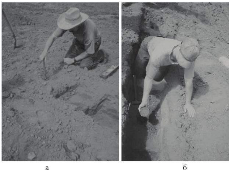
Рис. 2. Визначення твердості та відбір проб ґрунту: а – визначення твердості в дослідних шарах; б – процес відбору проб ґрунту в дослідних шарах
