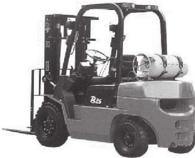
Рис. 3. Навантажувач із змінними балонами з пропан-бутаном
