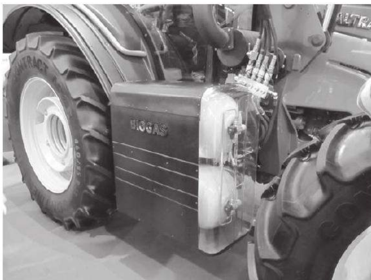
Рис. 2. Трактор з газобалонним устаткуванням живлення двигуна
