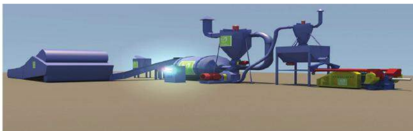
Рис. 4. Схематичне зображення технологічної лінії виробництва брикетів на базі преса ВЕВ-800
