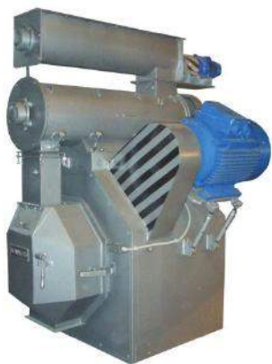
Рис. 2. Гранулятор з кільцевою матрицею: а – загальний вигляд; б – удосконалений вузол
