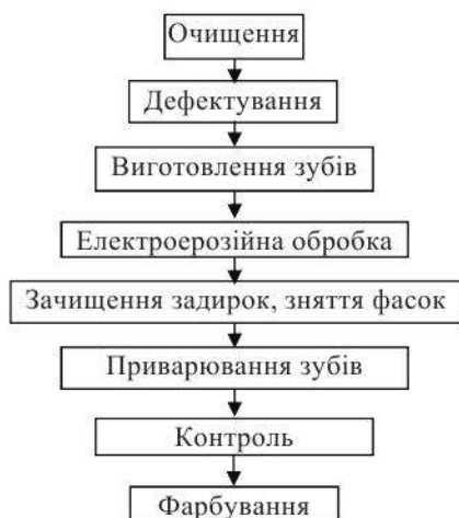
Рис. 2. Схема технологічного процесу відновлення і зміцнення важких борін
