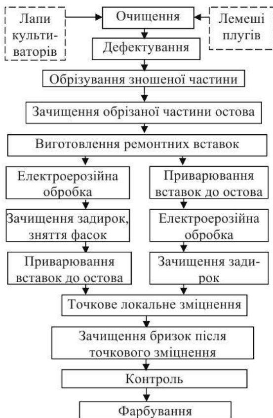
Рис. 1. Схема технологічного процесу відновлення і зміцнення лап культиваторів та лемешів плугів
