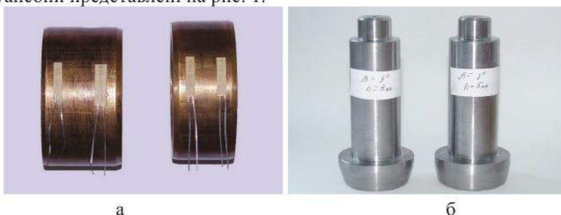
Рис. 1. Застосовувані зразки та пуансони: а – зразки; б – обробні пуансони
