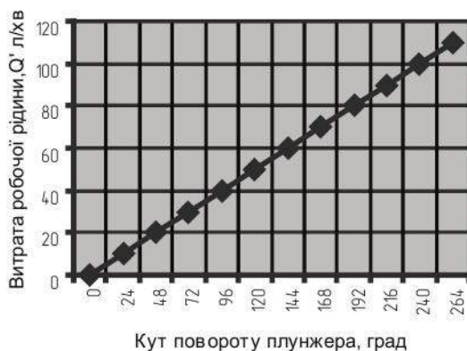
Рис. 6. Тарувальна характеристика витратоміра постійного перепаду тиску
