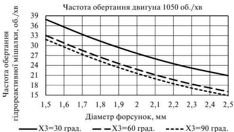
Рис. 5. Залежність частоти обертання гідрореактивної мішалки від діаметра форсунок
