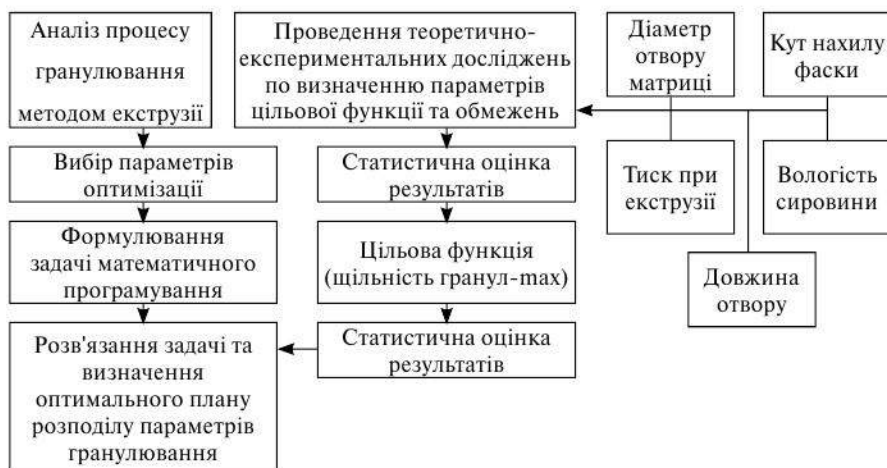
Рис. 2. Методичний алгоритм визначення конструкційно-технологічних параметрів процесу екструзії біомаси
