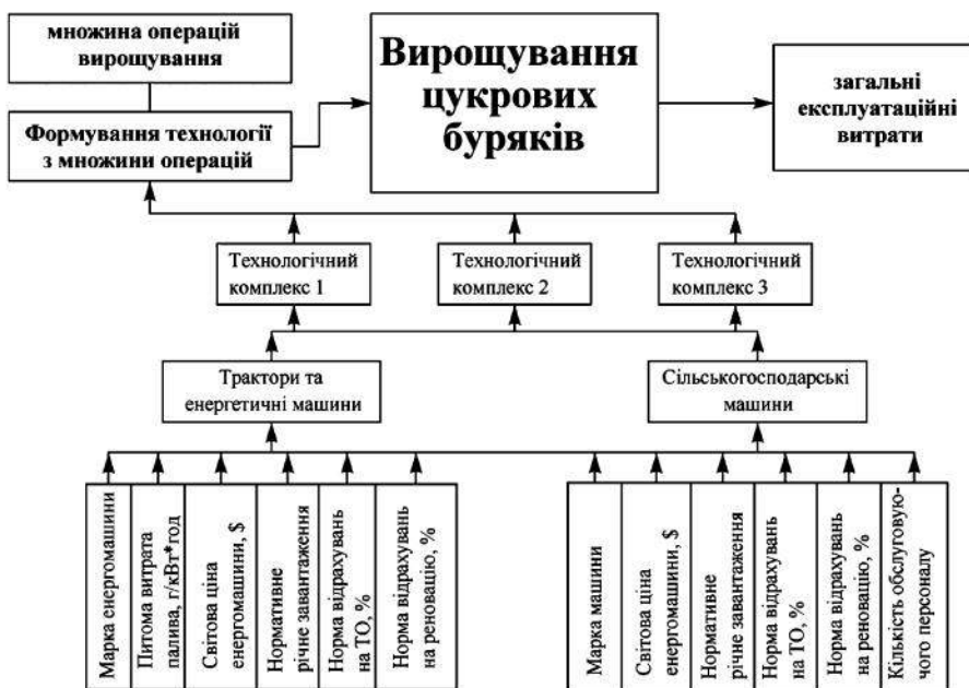
Рис. 1. Схема техніко-економічної моделі вибору технологічного комплексу для вирощування цукрових буряків
