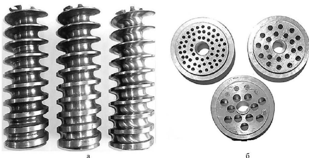
**Рис. 3.** Гвинти з різною інтенсивністю зміни розмірів каналу за довжиною (а) та матриці з різною кількістю та діаметром отворів (б)
