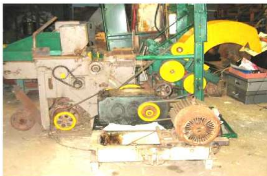
Рис.1. Експериментальна установка для вивчення доподрібнення зерна кукурудзи та питомої енергоємності процесу.
