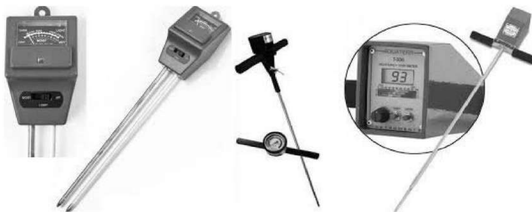
Рис. 1. Щільноміри ґрунту Fig. 1. Devices for measuring the density of soil
