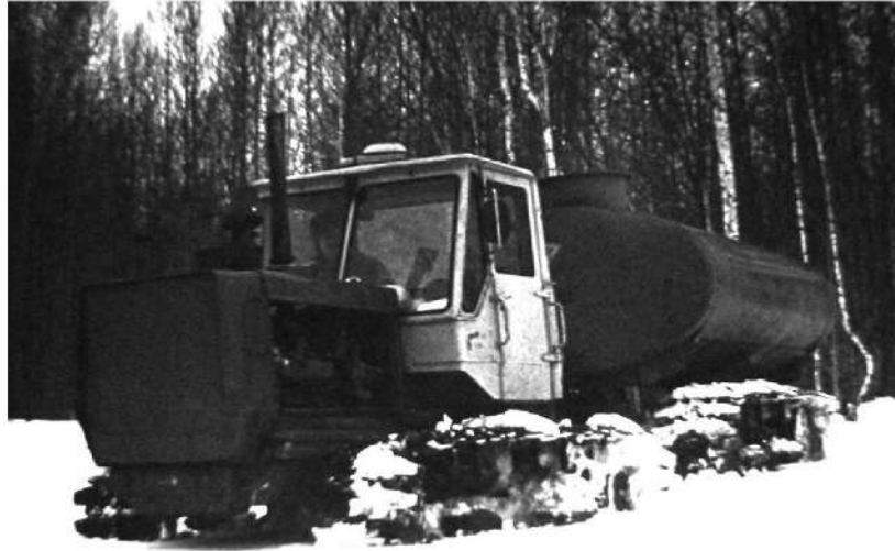
Рис. 12. Горизонтальне положення гусеничного рушія нерухомого ТТЗ на глибокому сніговому покриві
