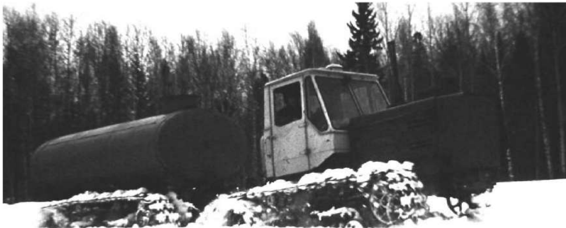
Рис. 13. Поступове занурення гусеничного рушія в сніговий покрив зменшує потужність на утворення колії
