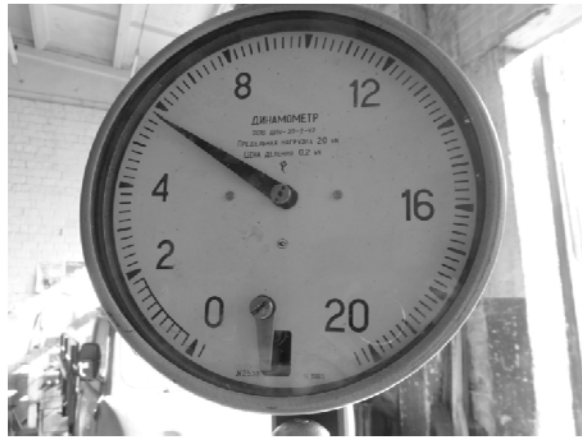
Рис. 1. Визначення величини ваги та координат центру мас начіпного знаряддя Fig. 1. Determination of the weight and coordinates of the center of the mass of the hinged gun
