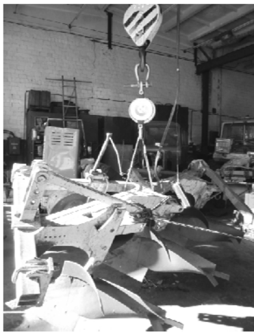
Рис. 1. Визначення величини ваги та координат центру мас начіпного знаряддя Fig. 1. Determination of the weight and coordinates of the center of the mass of the hinged gun
