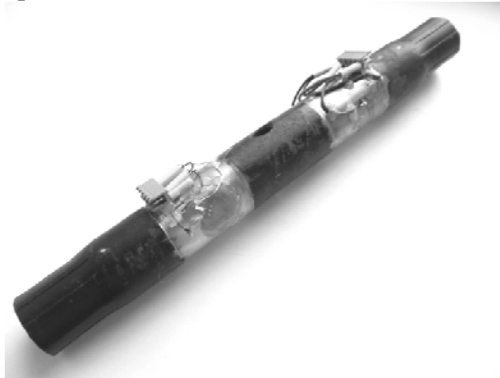
Рис. 2. Центральна тяга заднього начіпного пристрою трактора КІЙ 14102 з наклеєними тензорезисторнимим мостами
