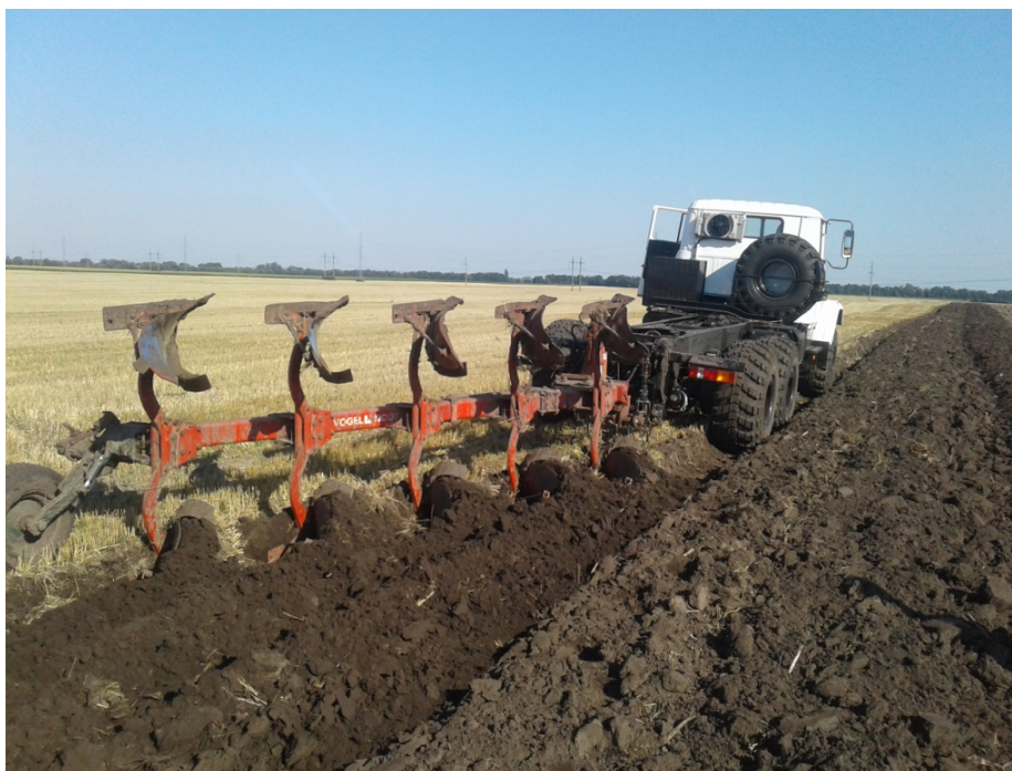
Рис. 2. Орний агрегат: MEZ-330 + плуг XMS 950 Fig. 2. Orion aggregate: MEZ-330 + plow XMS 950
