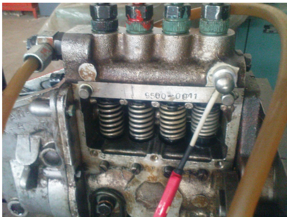
Рис.1. Паливний насос УТН-5 з встановленим датчиком конструкційної акустики серії АВС
