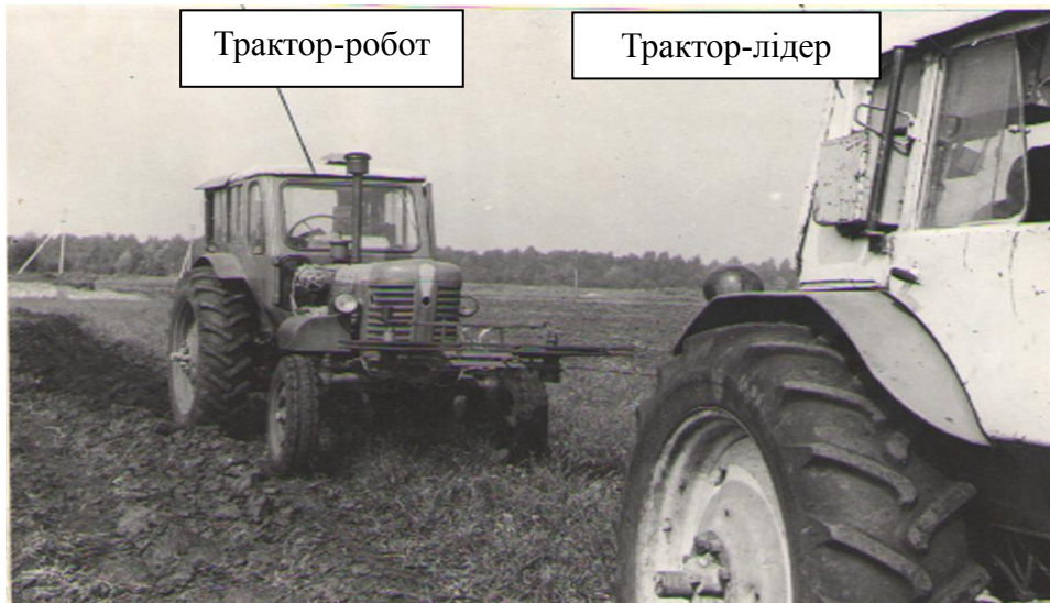
Рис. 1. Система автоматичного управління МТА на оранці в режимі дублерного управління Fig. 1. The system of automatic control of the MTA in the plow in the mode of dual management
