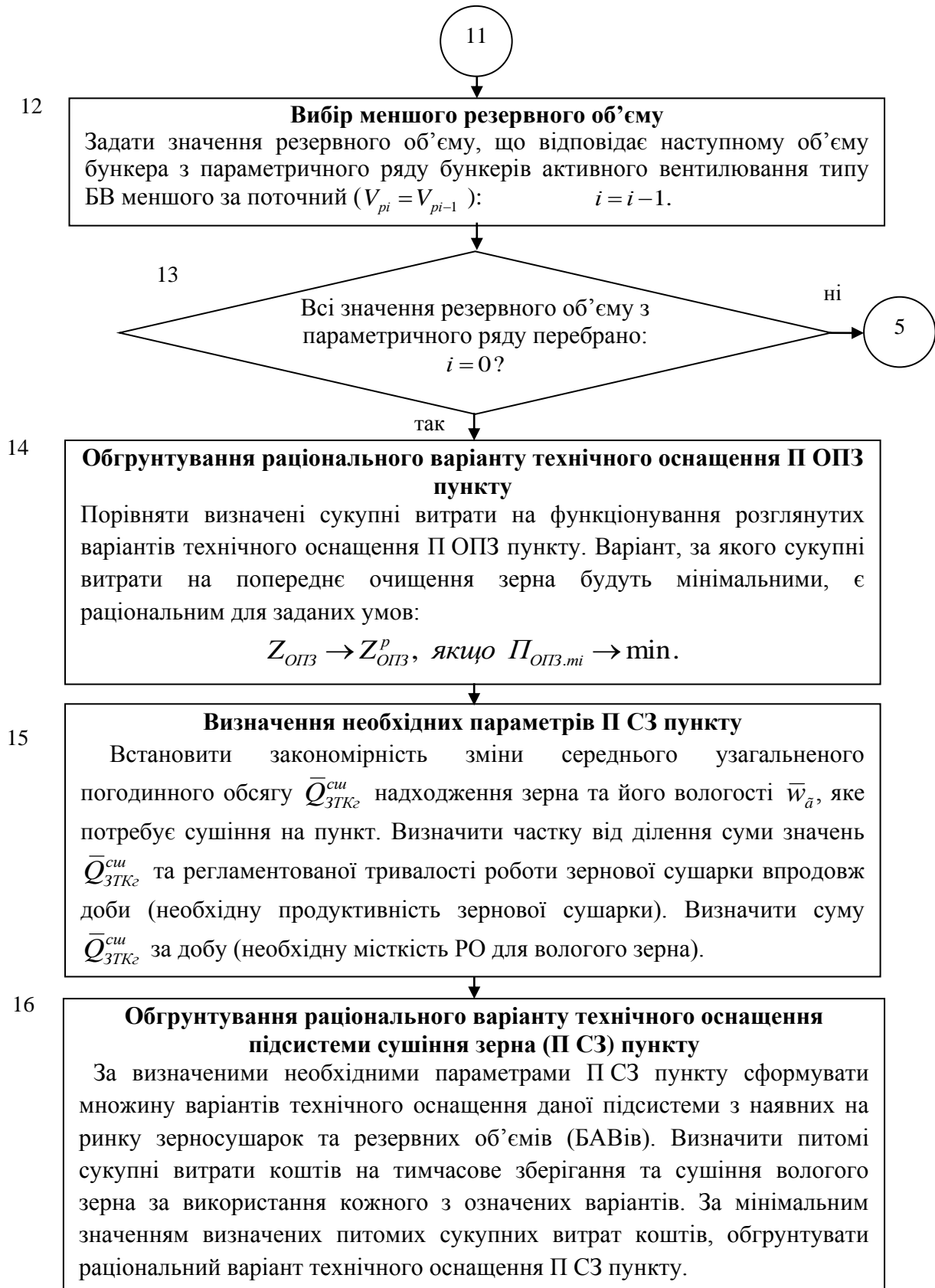
Рис., арк. 3. Блок-схема алгоритму методу обґрунтування раціональних параметрів пунктів післязбиральної обробки зерна
