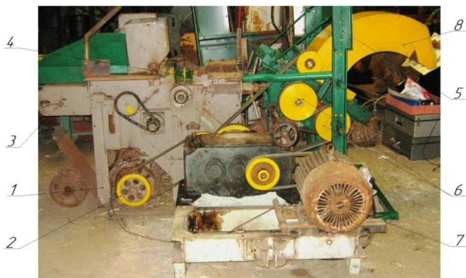
Рис.1. – Експериментальна установка для вивчення доподрібнення зерна кукурудзи:
