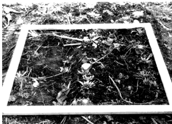
Рис. 2. Визначення якості видалення гички дослідною гичкозбиральною машиною Fig. 2. Determination of quality of tops removal by studied beet tops harvesting machine
