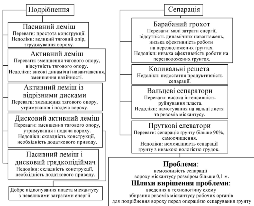
Рис. 7. Класифікація та аналіз робочих органів для викопування та сепарації ризомів міскантусу Fig. 7. Classification and analysis of working bodies for the digestion and separation of mescanthus rhizomes
