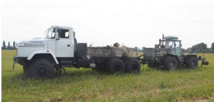
Рис. 2. Тягові випробування МЕЗ-330 «Автотрактор»
