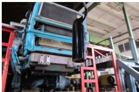
Рис. 2. Установка датчика ПВГП на тракторі Т-150К Fig. 2. Installation DDDS sensor on the tractor T-150K
