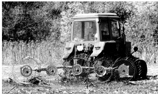
Рис. 4. Згрібання стебел соняшнику колісно-пальцевими граблями
