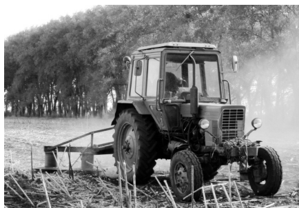
Рис. 3. Скошування стебел соняшнику ротаційною косаркою
