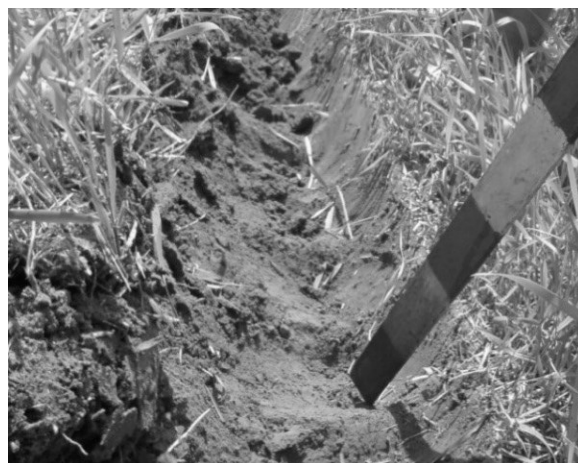
Рис. 4. Профіль дна борозни після проходження вирізного диска
