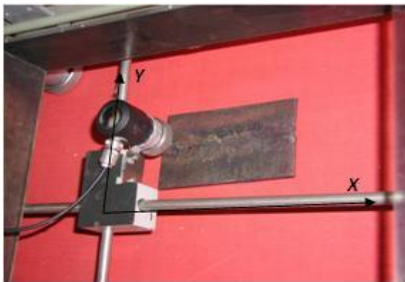
Рисунок 3 – Безконтактний ультразвуковий перетворювач та досліджуваний зразок
