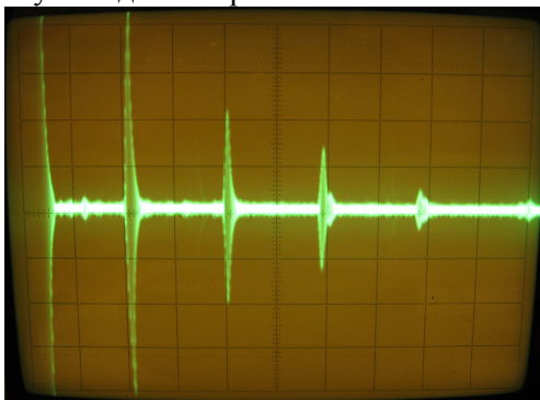
Рисунок 2 – Типова форма для імпульсів хвиль Релея при багатократному оббіганні поверхні муфти обсадної труби, яка була в експлуатації
