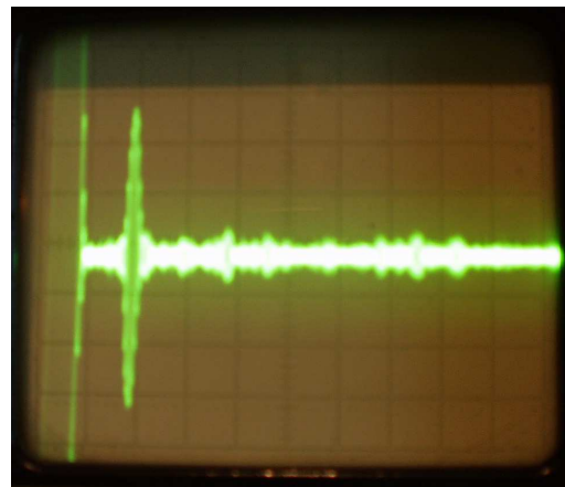
Рисунок 4 – Реалізація з сигналом від дефекту в вигляді пазу глибиною 0,2 мм, розкриттям 0,2 мм і довжиною 16 мм
