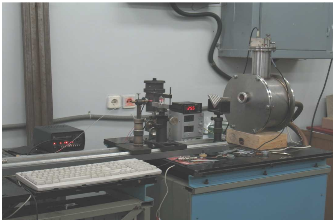
Рисунок 5 – Загальний вигляд установки лазерного флеш-методу для вимірювання теплопровідності тонких плівок
